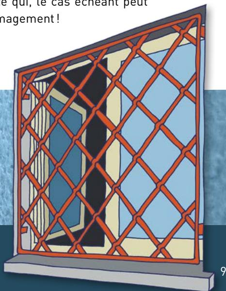
*On empêchera l'écartement des barres de la grille d'une fenêtre en l'équipant de renforts transversaux.*
